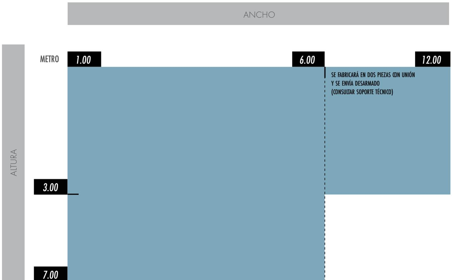
Para cortinas con anchos superiores a 6.00 mts. se fabricarán en dos piezas con unión y se enviará desarmado.
